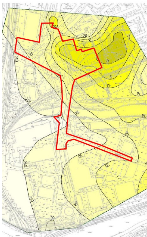
Ungefärliga jorddjup i planområdets södra del. Röd markering från geoteknisk utredning visar område för befintlig trafikviadukt, Byfogdegatan, kv Långan, Norra Torget samt nytt läge för Slakthusgatan.
